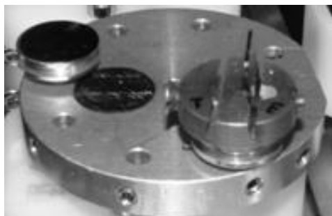
Рис. 2.11. Держатели на предметном столике с закрепленными образцами
