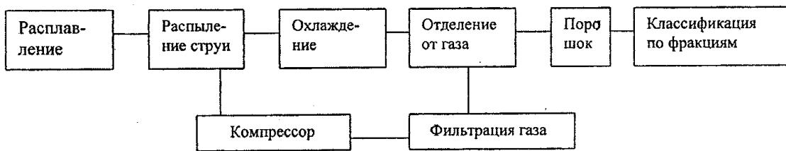
**Рис. 3.3.2. Технологическая схема получения порошка из расплава.**
