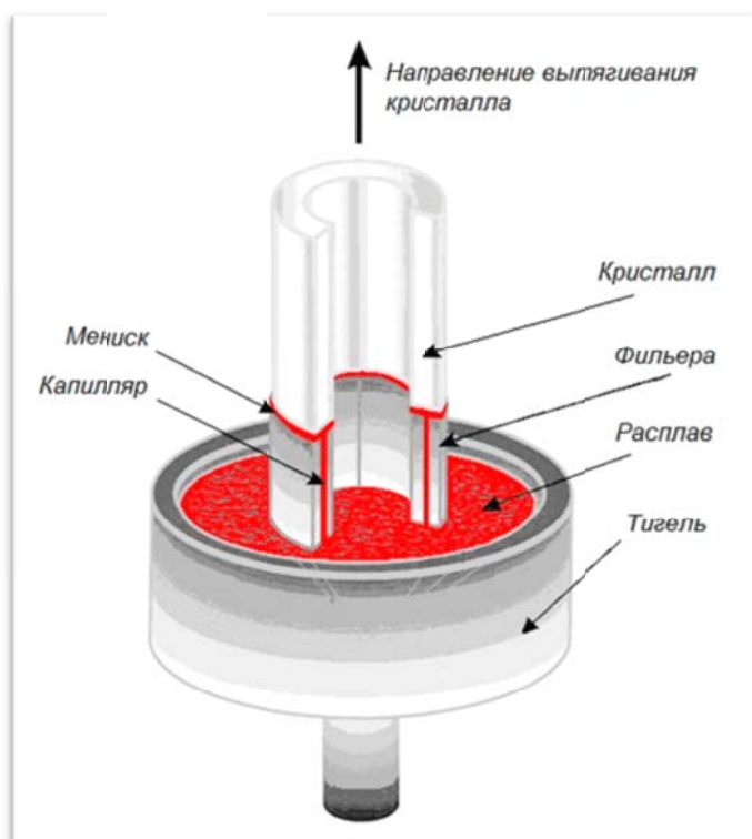
Рис. 2. Выращивание профилированных кристаллов сапфира способом Степанова
